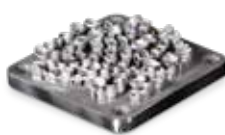
Production de prothèses dentaires partielles, de couronnes et de bridges en LaserForm CoCr (C)
